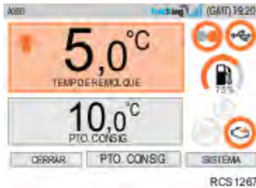
Ilustración 35. Se muestra la pantalla del modo de calefacción
