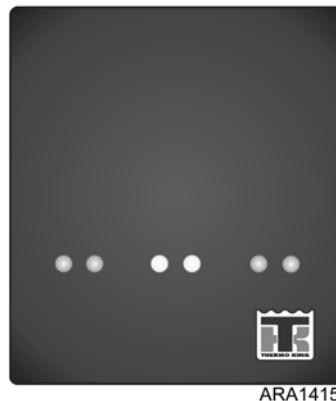
Figura 16: Alarma de apagado
