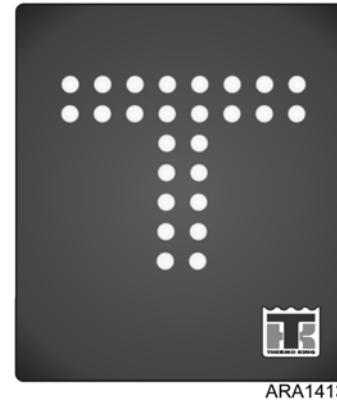
Figura 14: Funcionamiento normal sin alarmas
