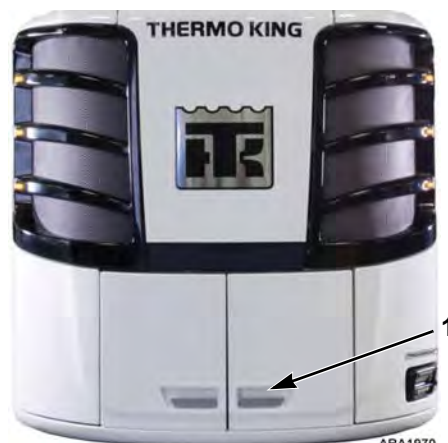
Figura 10: Ubicaciones de pestillos de la puerta
